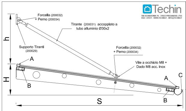
TUTTI I PROFILI SONO REALIZZATI IN ALLUMINIO VERNICIATO A POLVERI POLIESTERE LEGA 6060 STATO T5 o T6 CON UNO SPESSORE VARIABILE TRA 1,5 - 2 mm. (scala 1:2)
