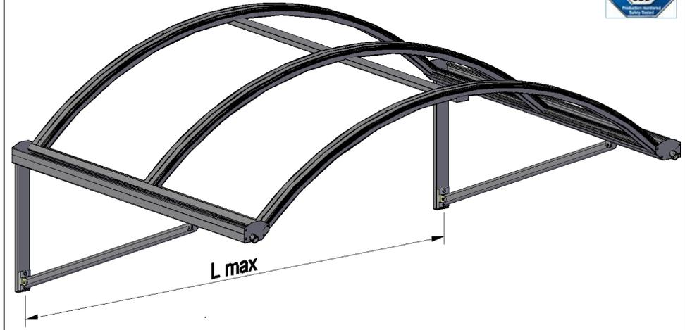
TUTTI I PROFILI SONO REALIZZATI IN ALLUMINIO VERNICIATO A POLVERI POLIESTERE LEGA 6060 STATO T5 o T6 CON UNO SPESSORE VARIABILE TRA 1,5 - 2 mm. OVE NON DIVERSAMENTE INDICATO (scala 1:2)
