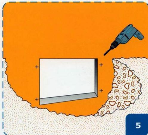
Con un trapano praticare i fori in cui alloggeranno i fissaggi della bocca di lupo.
