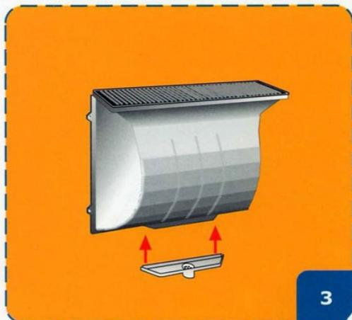
Fissare il bocchello di scarico dall'esterno mediante le due viti autofilettanti già predisposte.
