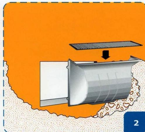
Montare la griglia avvitando le relative barrette anti-intrusione. Il montaggio deve avvenire con la griglia alloggiata nella bocca di lupo.
