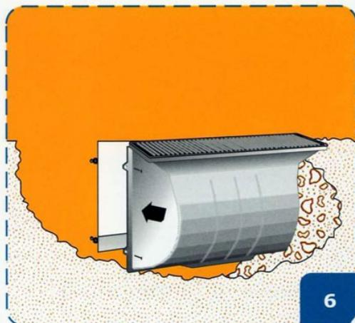
Avvitare i fissaggi, in dotazione, con le relative rondelle.
